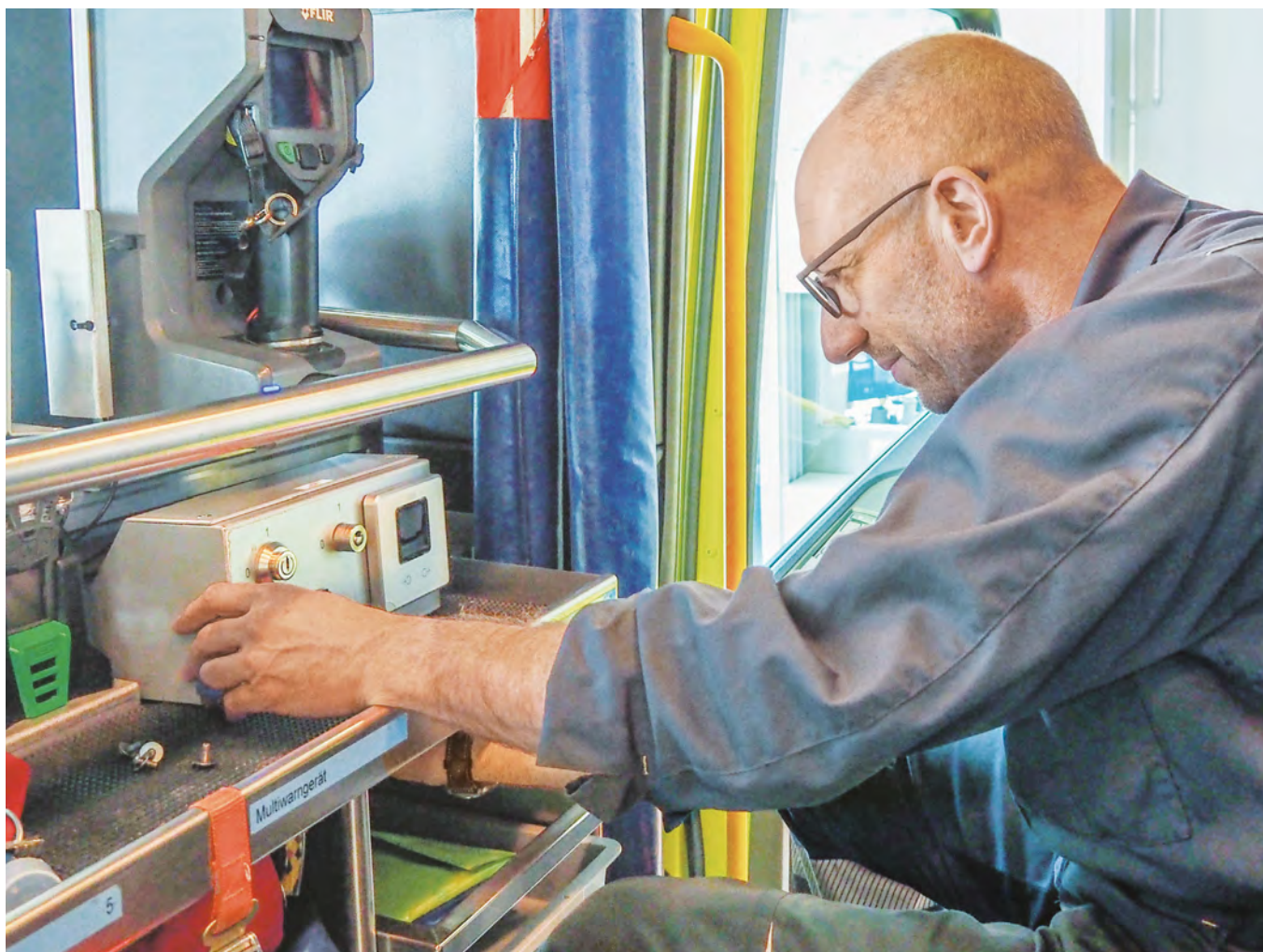
Die Abteilung Fahrzeuge baute die Schlüsseltresore in die Einsatzfahrzeuge ein, die mittels Fingerabdruck-Scan entsperrt werden können (siehe ebenfalls Bild rechts oben).
