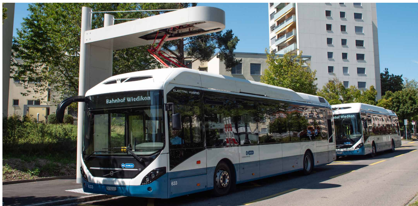
VBZ-Elektrobusse an der Ladestation Dunkelhölzli. Foto: Verkehrsbetriebe Zürich
