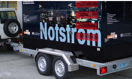
Der mobile ewz-Notstromgenerator (200 kVA) im Einsatz.
