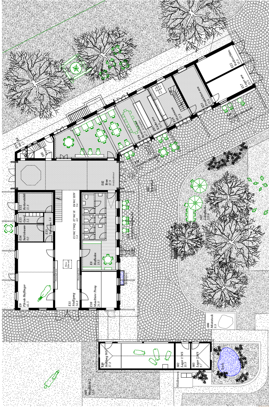
Grundriss EG, Abbruch gelb, Neubau rot
