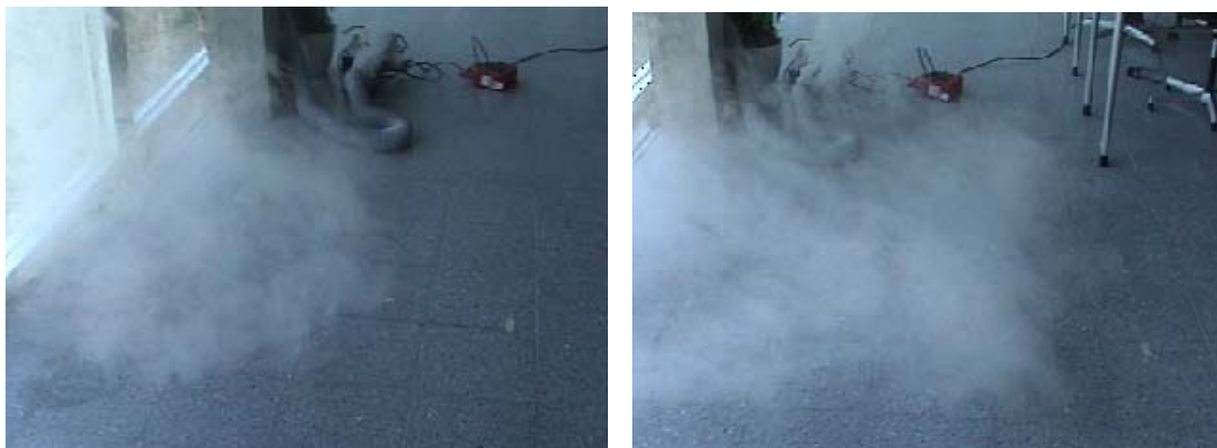
Bild 3a: Strömungsvisualisierung mit Rauch an Fassade Eschenbach.
