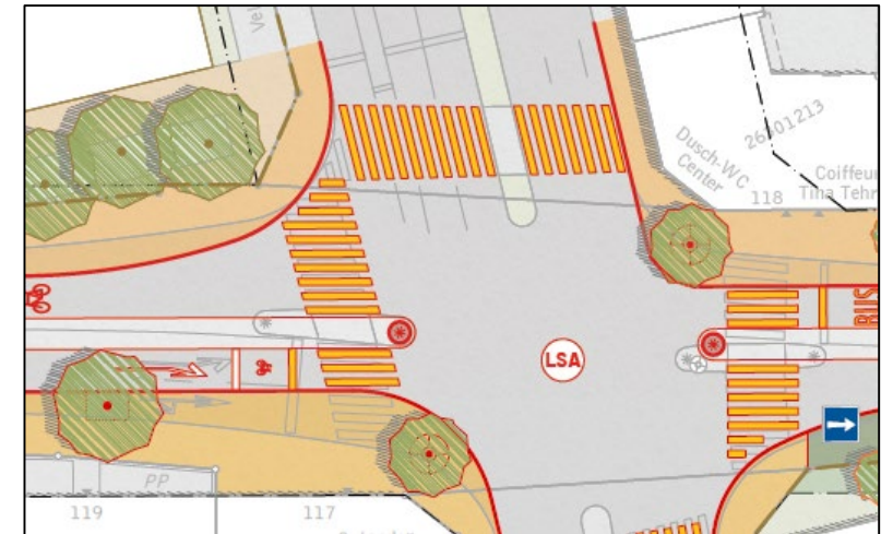
Stufe III: Strassenbauprojekt mit Umbauten, Bäumen und Aufhebung von Fahrbeziehungen
