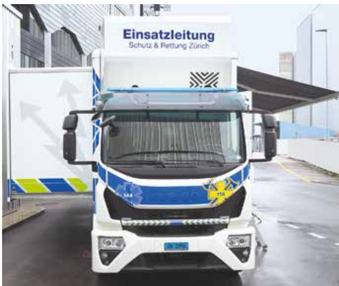
In ausgefahrenem Zustand bietet der Rapportraum dank dem Slide-out (links im Bild) Platz für bis zu 20 Personen.
