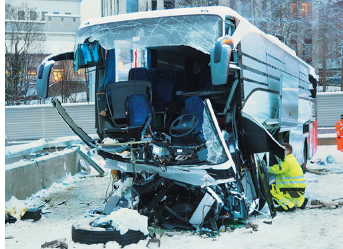
Die Front des Reisebusses wurde beim Aufprall auf die Begrenzungsmauer massiv deformiert.
