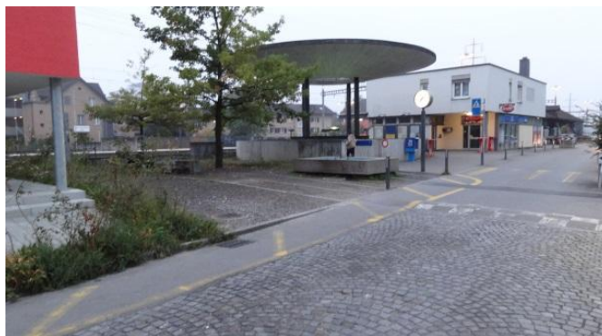
Defizit ⑤: Fussgängerlängsstreifen gelb markiert („Aargauer Trottoir“) ist bzgl. Verkehrssicherheit suboptimal.
