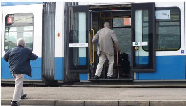
Defizit ❸: Haltekanten nicht behindertengerecht
