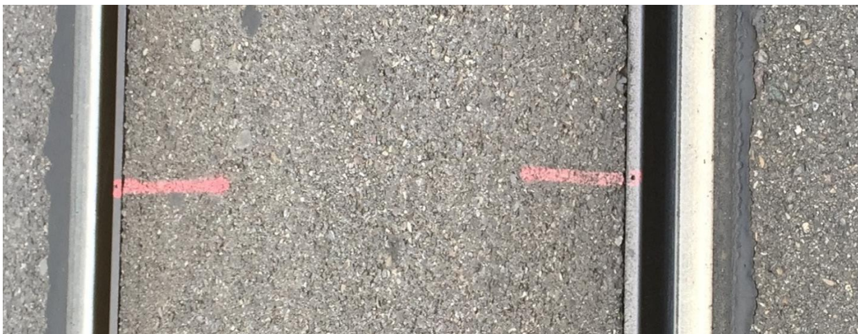
Abbildung 1: Anordnung der Messkörner auf Rillenkopf Rillenschiene
