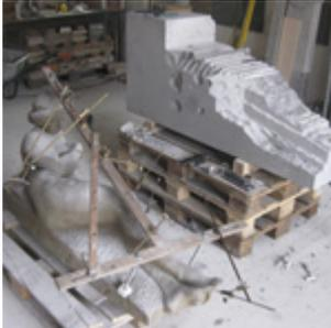
Präzises Ausmessen des Steinblocks; Einrichten der Hauptpunkte
