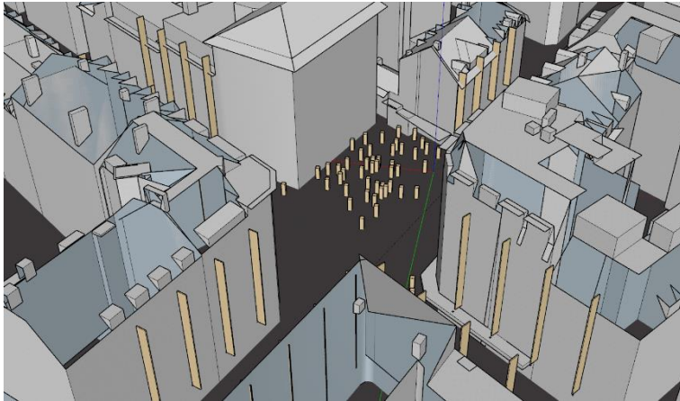
Abbildung 41: Absorbierende Elemente an den Fassaden.
