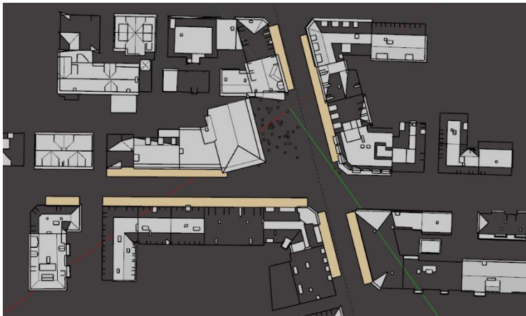
Abbildung 55: Sicht von Oben mit den eingebrachten Schallschutzschirmen.
