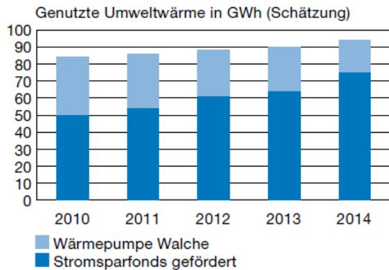
**Abb. 2** Die Nutzung der Umweltwärme steigt. Der Anteil der Erdwärmesonden-gekoppelten Wärmepumpen liegt vermutlich im Bereich von 40%. Quelle: [Jahresbericht Energiepolitik Stadt Zürich 2014](#); Daten: Stromsparfonds Stadt Zürich und Schätzungen AHB aufgrund von Daten AWEL, Kanton Zürich.
