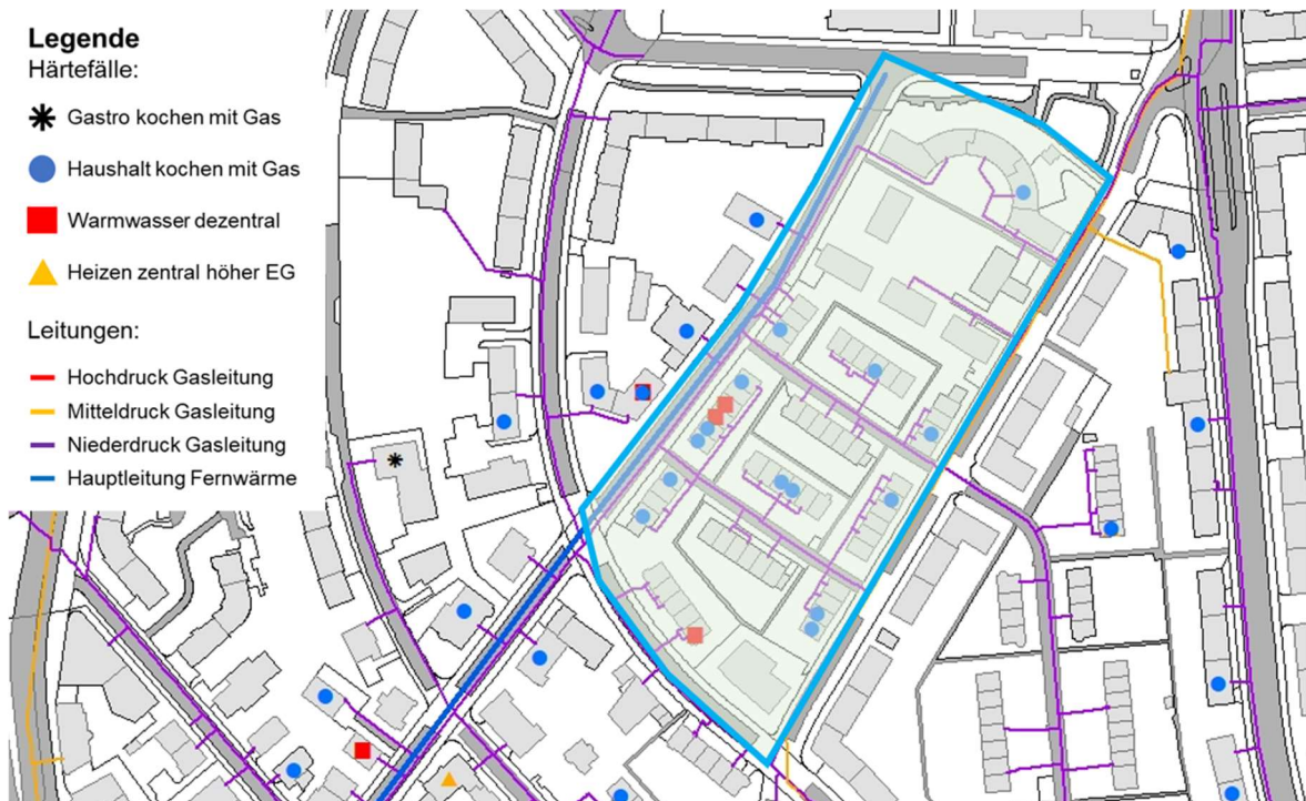
Abbildung 16: Situationsplan Gasnetz Im Eisernen Zeit. Betroffener Perimeter.
