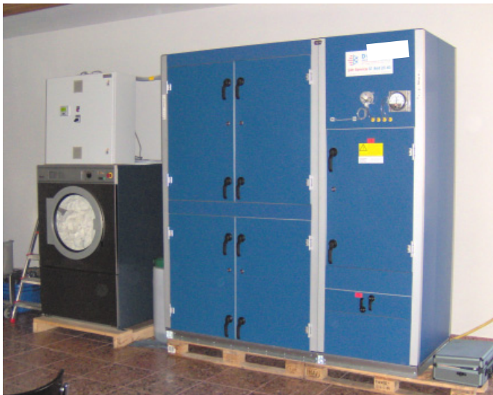
Figur 6 Wärmepumpenanlage zu umgebautem Miele Tumbler 15 kg (Event 2005, Bild J. Nipkow)
