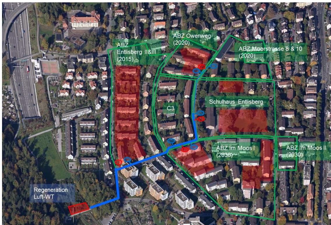
Figur 16: Pilotareal ABZ Entlisberg (grün: angeschlossene Wärmebezügler, blau: NT-Leitung, rote Fläche: EWS-Feld).
