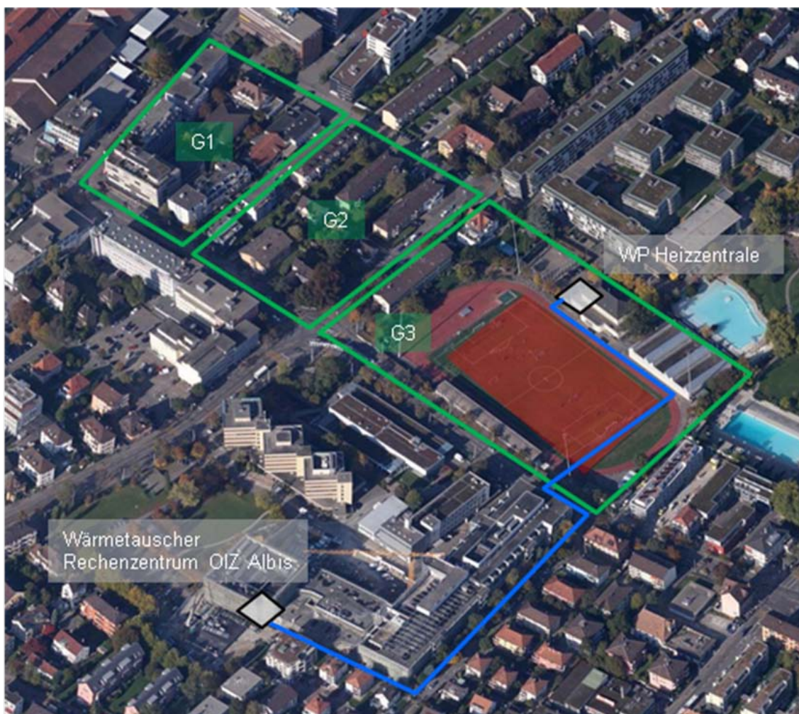
Figur 13: Pilotareal OIZ (grün: angeschlossene Wärmebezüger, blau: NT-Leitung, rote Fläche: EWS-Feld).
