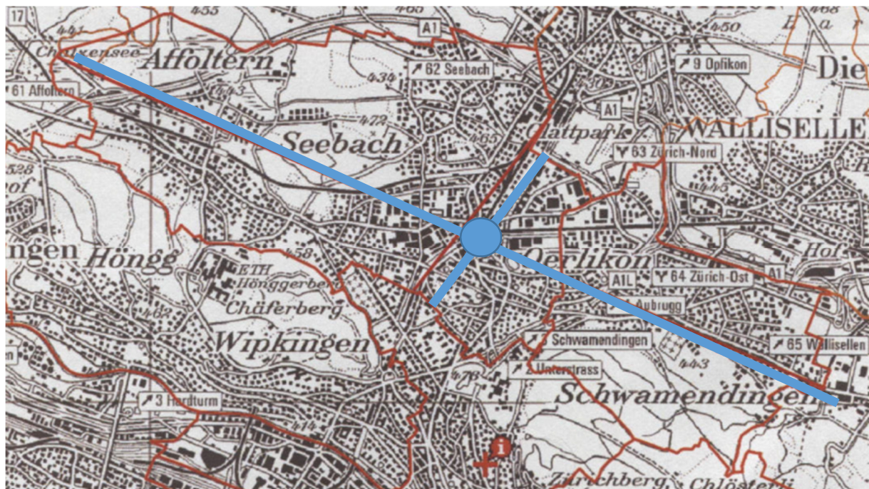
Abbildung 5: Bestimmung des «virtuellen» Zwischenlagers im Stadtgebiet Zürich Nord (Affoltern, Oerlikon, Schwamendingen). Mittels zweier Linien wird der ungefähre Schwerpunkt bestimmt (blauer Punkt). Auf diesem liegt das «virtuelle» Zwischenlager (Quelle: GIS-ZH, Kanton Zürich).
