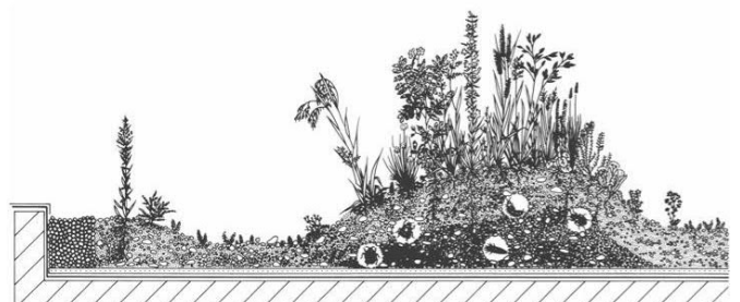
Einrichtung von Hügeln schafft Kleinlebensräume mit erhöhter Feuchtigkeit.
