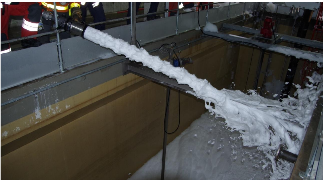
Bild 12: Schaum bei 3,8 bar Druck am M2 Rohr (Quelle: Holger de Vries)
