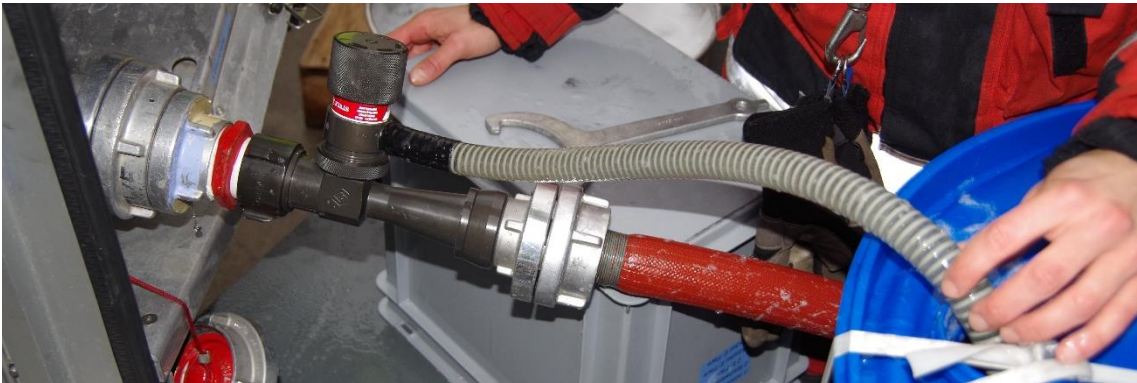
Bild 15: Zumischer Akron Brass 95 GPM am TLF (Quelle: Holger de Vries)
