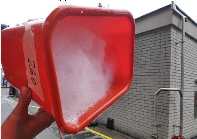
Bild 8: Schaum 30 min. nach Abgabe mit M2-Rohr (Quelle: Jonas Kohler)
