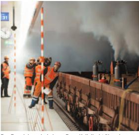
Der Rauch kann bei einem Brandfall direkt über den Geleisen abgesaugt werden. 60 Rauchklappen sind dafür seitlich oberhalb der Perrons installiert und werden dem Vorfall angepasst automatisch angesteuert. Um eine Rauchausbreitung aus dem Weinbergtunnel in den Tiefbahnhof zu verhindern, würde im Notfall eine grosse Rauchklappe den aus dem Tunnel strömenden Rauch vor dem Bahnhofsteil absaugen.
