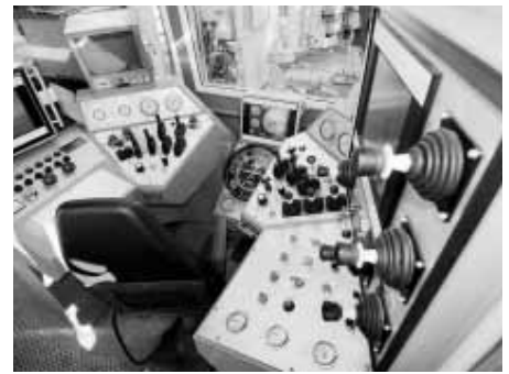
Führerkabine des Bohrturmes.
