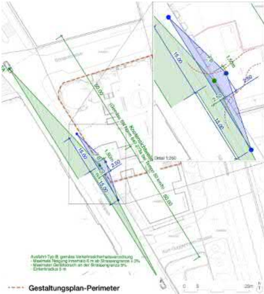
Abbildung 39 Knotensichtweite Anschlussknoten Talstrasse (Quelle: IBV Hüsler AG)
