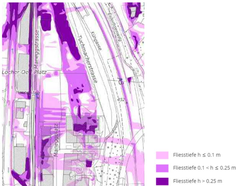
Abbildung 5: Gefährdungskarte Oberflächenabfluss (Quelle: www.maps.zh.ch)
