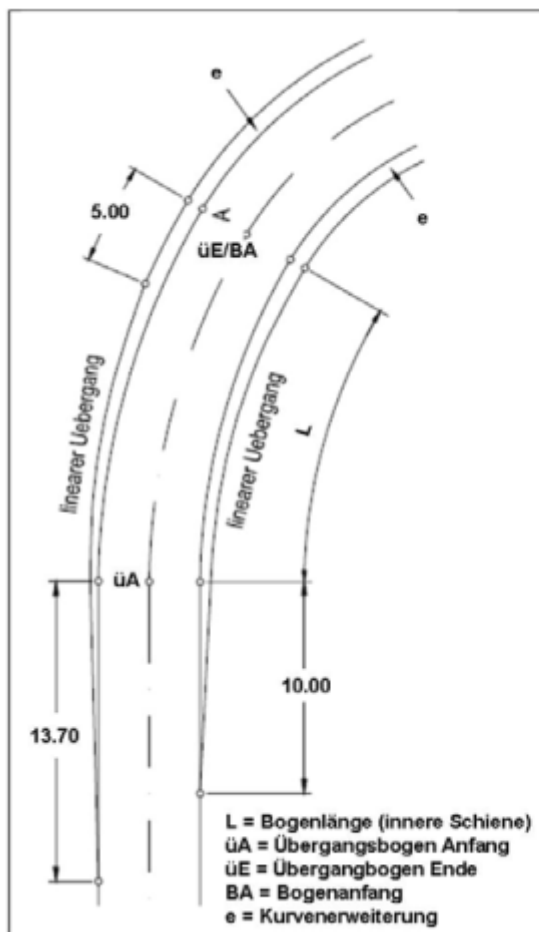
Gleise mit Übergangsbogen
