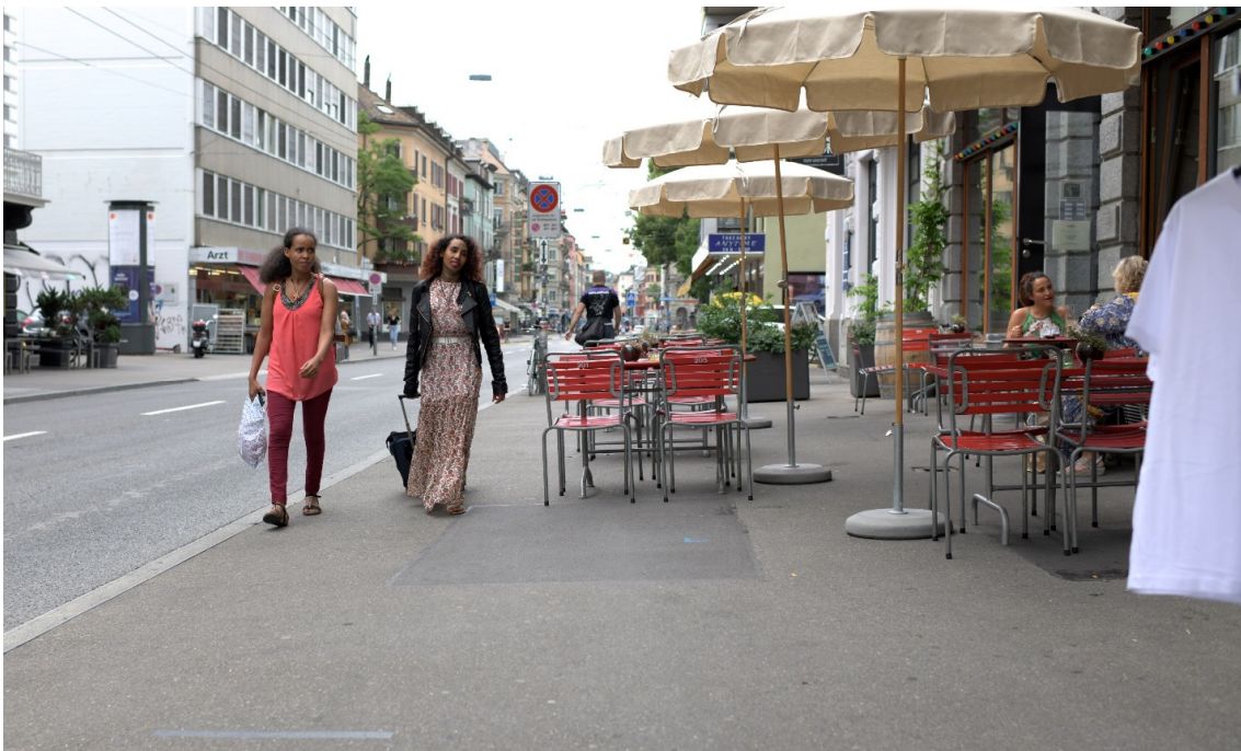
Langstrasse (Bedeutung: regional/stadtweit): keine ausreichende lichte Breite aufgrund Aussenbestuhlung, keine ausreichenden Umfeldzuschläge zum Strassencafé und zur Fahrbahn hin.
