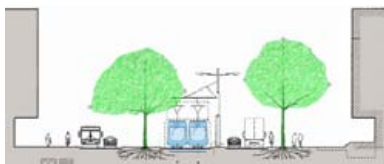
Querschnitt durch die Thurgauerstrasse mit Blick stadtauswärts. Das Trasse der projektierten Stadtbahn und die Fahrbahnen stadtauswärts liegen zwischen, die Fahrbahnen stadteinwärts seitlich der heutigen Baumallee.
