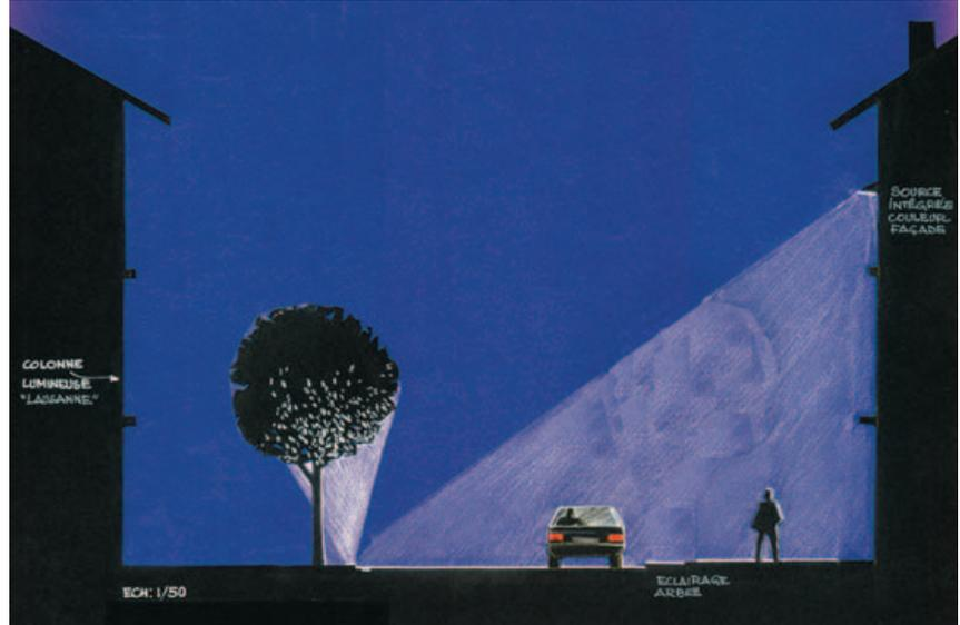
*Beleuchtung der Platzoberfläche mit an Fassaden montierten Leuchten. Nach sorgfältiger Prüfung können auch Bäume angestrahlt werden (evtl. jahreszeitenbezogene Lichtsteuerung wegen Lichtverschmutzung).*
