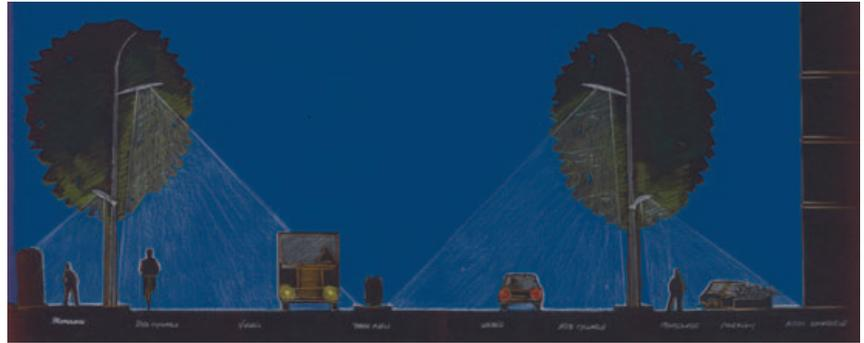
*Seitliche Beleuchtungskandelaber betonen den zumeist heterogenen Strassenraum der Einfallsachsen. Gleichzeitig nehmen sie die Beleuchtungskörper für die Gehbereiche auf. Bei Baumreihen können die Leuchten in der Perspektive der Raumflucht verdeckt sein. Dadurch wird die Tiefensicht in der Achse und seitlich verbessert.*
