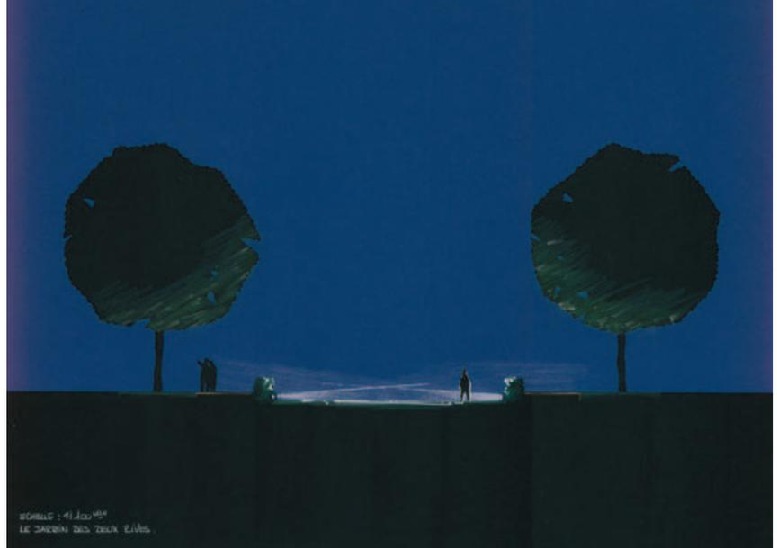
*Licht auf Bodenniveau führt den Fussgänger und zeichnet die Oberflächenstruktur des Weges. Um auf Kopfhöhe eine ausreichende Lichtmenge zu erhalten, ist diese Art der Beleuchtung allenfalls mit zusätzlichen Leuchten zu ergänzen. Dies hängt von der Umgebungsbeleuchtung ab.*
