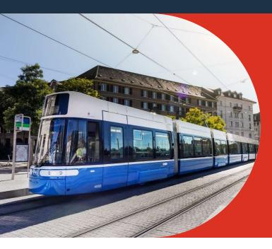
Die neuen Flexity-Trams für Zürich bieten 20 Prozent mehr Transportkapazität als die aktuelle Flotte und sind mit dem weltweit ersten zugelassenen Hinderniserkennungs-Assistenzsystem für höchste Sicherheit ausgestattet.
