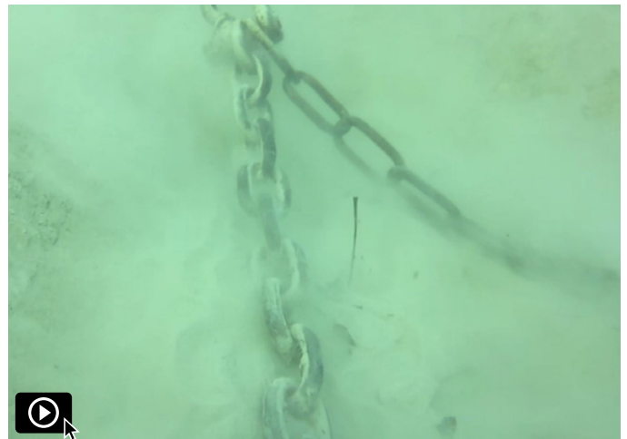
Durch Wellengang bewegte Ankerkette frisst sich in den Seegrund.
