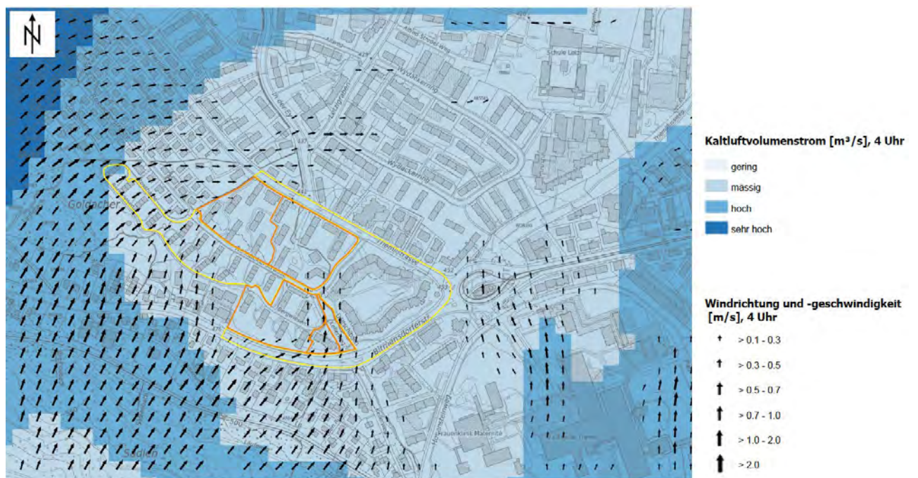
Abbildung 18: Kaltluftvolumenstrom, Windrichtung und -geschwindigkeit (Quelle: AWEL, 2018)
