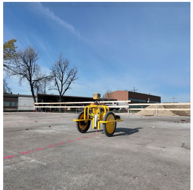
Abb. 46 (rechts) Absteckroboter TinySurveyor Terra markiert die Elemente (© Fieldwork AG, 25.04.2025)
