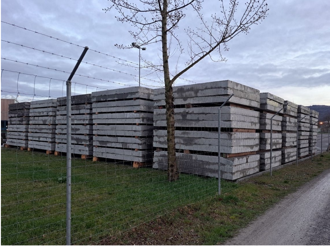
Abb.34 In Stapeln gelagert Tunnelplatten (© Zirkular, 05.06.2024)
