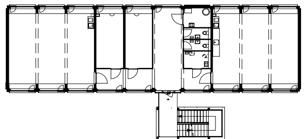
«Züri Modular»-Pavillon, «2. Generation» Standard-Grundriss, Obergeschoss 1:350
