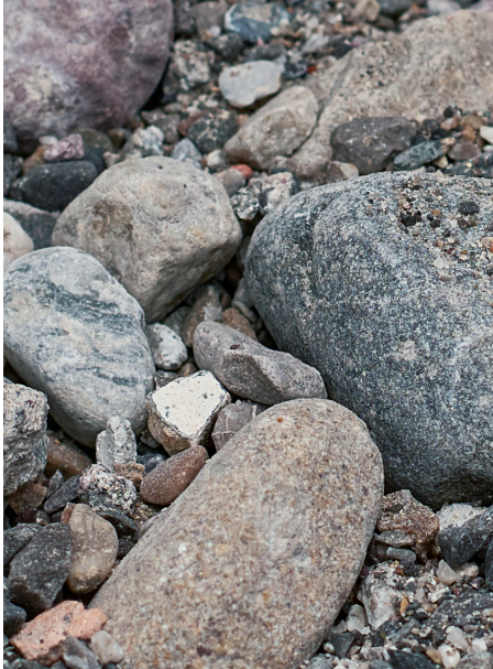
Zuschlagstoffe Primärbeton, Korngrösse 0–32 mm – 100 % natürliche Gesteinskörnung
