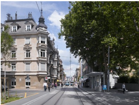
Haltestelle Feldeggstrasse. Enger Strassenquerschnitt, schmale Fahrbahnen im Mischverkehr. (Foto: Hannes Henz)
