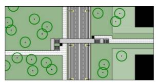
Überführungen oder Passerellen sind Brücken, die den Fuss- und Veloverkehr über Bahnlinien, Stadtautobahnen oder Hauptverkehrsachsen leiten. Eine Treppe oder eine Rampe führt auf die höhere Ebene. Lifte sind nur als Zusatzangebot vorzusehen, oder wenn eine Rampe nicht möglich ist.
