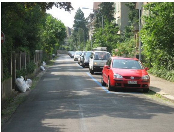
Möhlistrasse / Schanzackerstrasse. Einseitige Parkfelder innerhalb Tempo-30-Zone (Begegnungsfall MIV/Velo).
