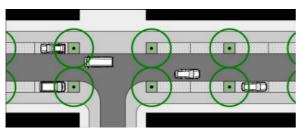
Längsparkfelder auf Trottoirniveau müssen einschliesslich Randstein mindestens 2.30 m breit sein. Setzen Sie wasserdurchlässige Beläge für Parkfelder ein und ordnen Sie diese zwischen Bäumen an.
