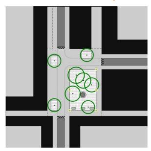
Bei funktionsvermischten Aufenthaltsplätzen befinden sich stadträumlich und verkehrlich gleich gewichtete Wege, Aufenthaltsstrassen, Fahrverbotszonen oder Sackgassen möglichst auf einer Ebene, das heisst, die Fahrbahnen werden für Sehbehinderte mit niedrigen Randabschlüssen von 3 cm vertikal oder 4 cm schräg abgegrenzt. Linear angeordnete Elemente sollen den Fahrbereich andeuten.
