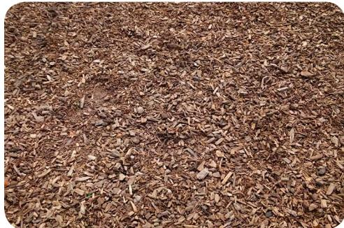
Fallschutzbeläge aus Holzschnitzel, Rundkies oder Sand werden vielerorts als Fallschutz unter Spielgeräten eingesetzt. Fallschutzsande und -kiese sind nach einer bestimmten Korngrösse sortiert und relativ grosskörnig. Eine ideale Fallschutzwirkung bei Holzschnitzeln ist gegeben, wenn die Schnitzel gleichmässig und eben verteilt sind und der organische Abbau noch nicht fortgeschritten ist. Der Fallschutzraum muss für eine ideale Fallschutzwirkung jederzeit locker und vegetationsfrei sein.
