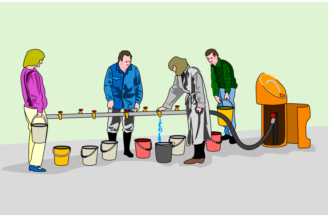
Geöffneter Notwasserbrunnen mit Verteilbatterie
